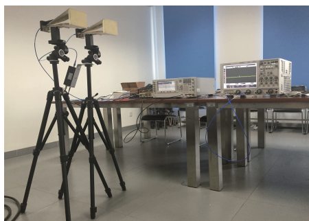
图8 脉冲时域散射测试环境
